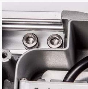
Está fijado en ambas partes por tornillos de acero inoxidable M8x16.
